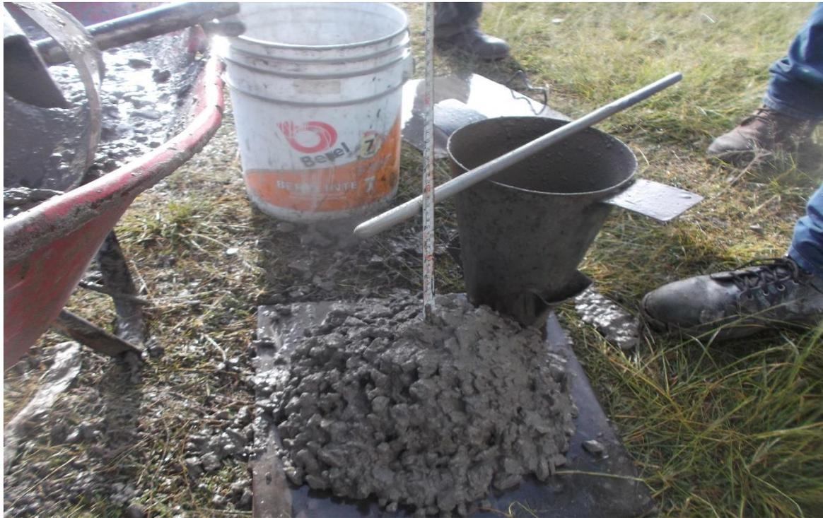
Prueba de revenimiento del concreto
